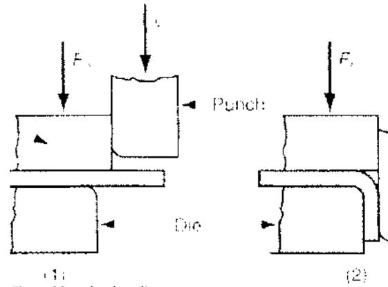
Figure22 : edge bending process
