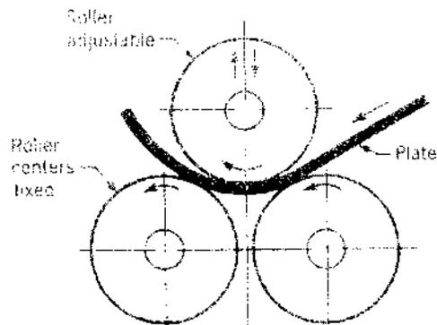
Figure 23 : Plate-bending rolls
